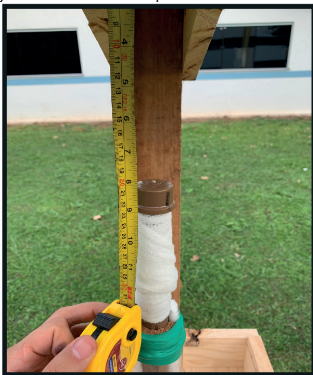
Figura 24 - Distância entre o topo da Vela úmida e a cobertura.
