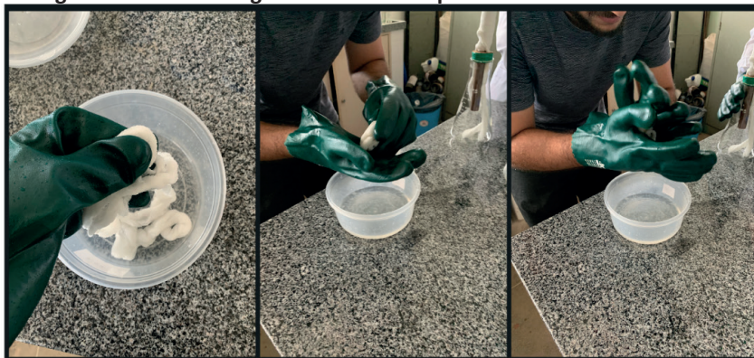
Figura 33 - Gaze Cirúrgica sendo torcida para retirada de íons cloreto.
