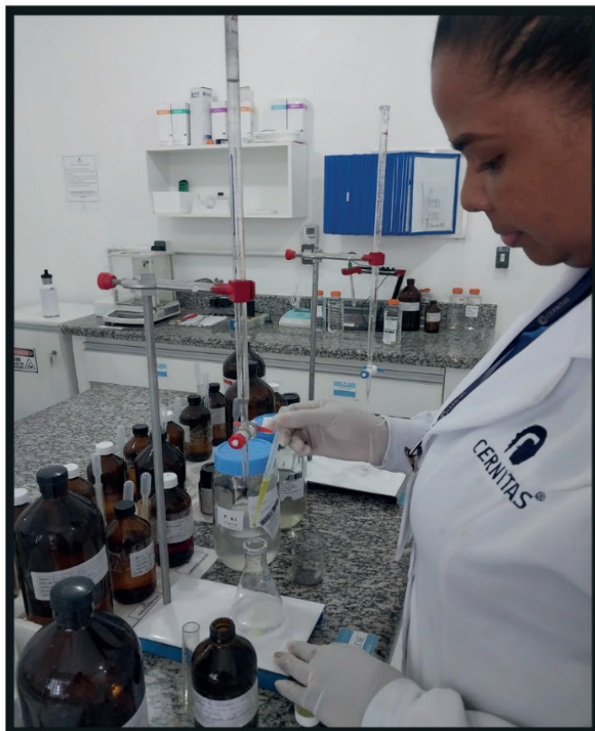
Figura 36 - Adição do indicador Cromato de Potássio à amostra.
