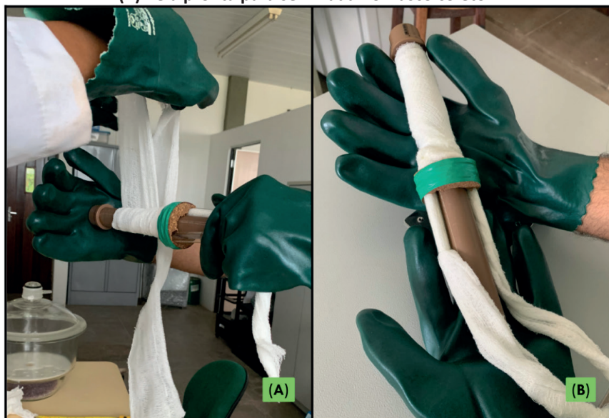
Figura 14 - Cilindro de PVC: (A) Gaze cirúrgica sendo enrolada; (B) Vela pronta para ser fixada no frasco coletor.
