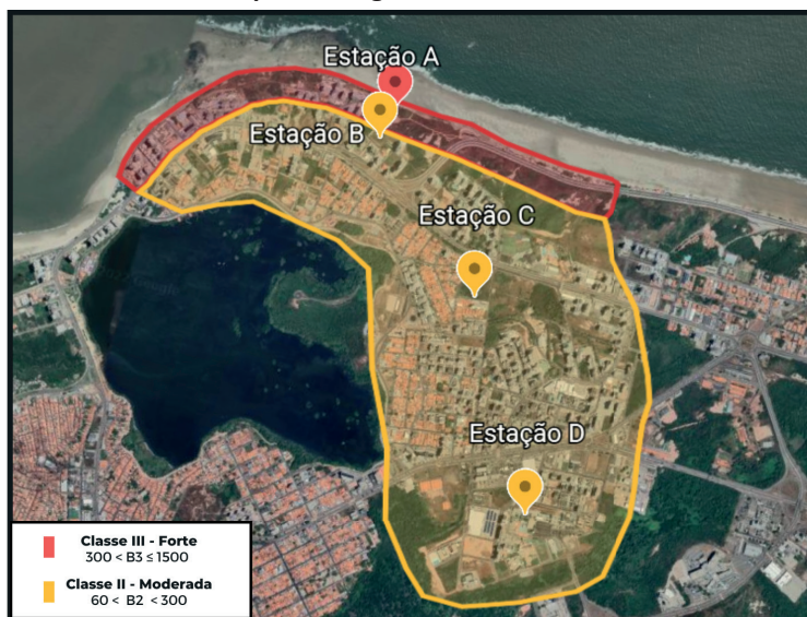
Figura 49 – Proposta de classificação da agressividade do ar atmosférico para as regiões estudadas.
